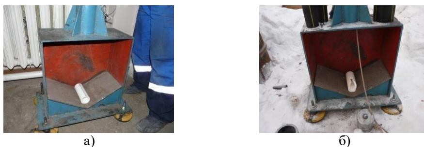
Рисунок 2 – а) испытания при 22°С, б) испытания при минус 15°С
