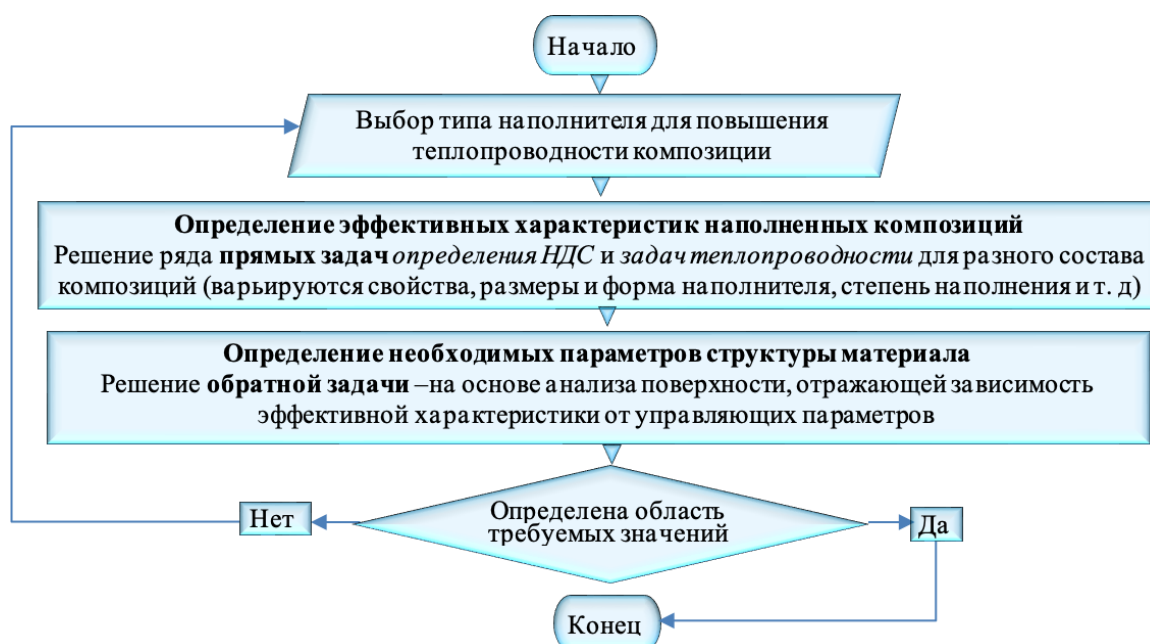
Рисунок 1 – Общая схема решения задачи компьютерного конструирования полимерной композиции с требуемым комплексом свойств
