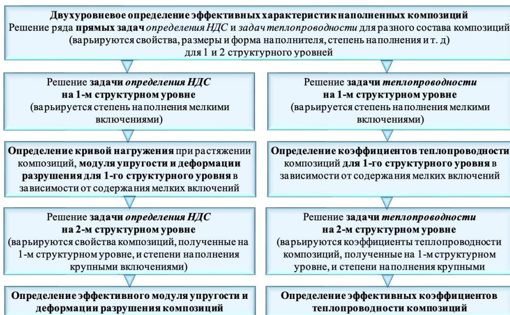
Рисунок 2 – Многоуровневый алгоритм решения прямых задач для определения эффективных физико-механических свойств наполненных полимерных композитов
