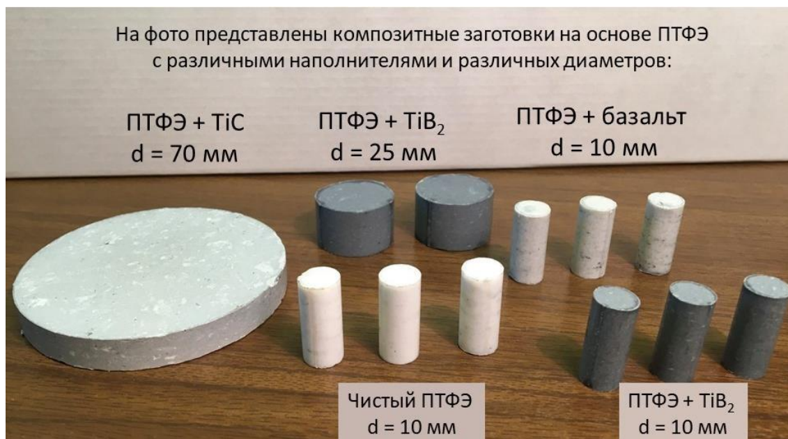
Рисунок 1 – Полученные методом холодного одноосного прессования композитные образцы на основе ПТФЭ с различными добавками диаметром от 10 до 70 мм
